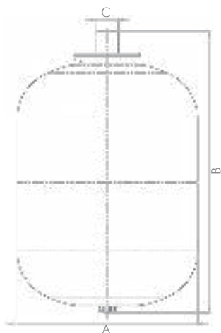
Расширительный бак ВП14 (арт. 7815)
